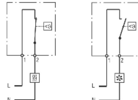
Вентилятор, устройство охлаждения, датчик
